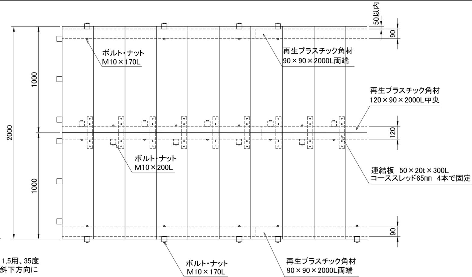
\* 階段本体に手摺を取り付ける場合は90×90の根太角材が階段端部から50mm以内に設置してください。
