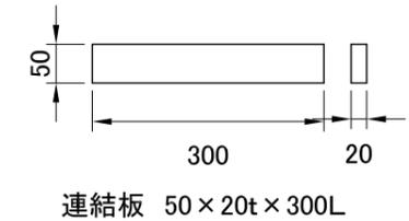
設置後地盤の変動などにより、左右のステップに段差や隙間ができるのを防ぐために使用します。コーススレッド65mm 4本止で連結して下さい。施工時の左右階段本体のズレを防ぎます。(ズレが累積すると調整が困難です。)
