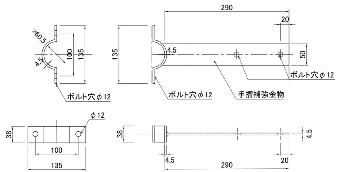
手摺補強金物 詳細図 S=1:5
